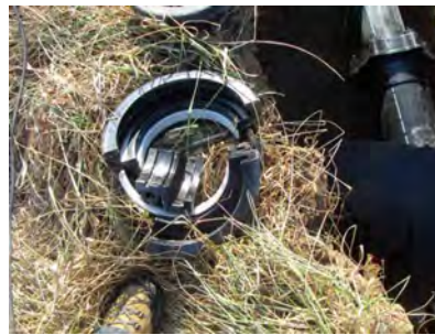
[Poor PE Joints]
