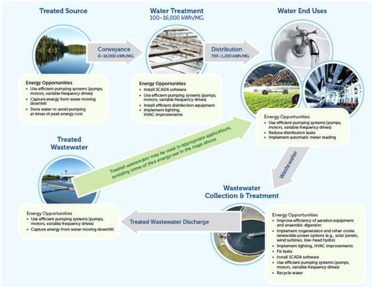
그림 69. 에너지 효율, 재생 에너지, 물 효율 향상이 적용 가능한 도시 물순환 시스템 각 단계별 에너지 강도
